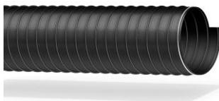
Flexibler Haushalts- und Industrie-Staubsaugerschlauch, auch zum Durchleiten von Wasser. Geeignet zum Absaugen von Schweißrauch ohne Funkenflug, cadmiumfrei, als Luftführungsschlauch im Maschinenbau, der Lüftungstechnik und in der Bautentrocknung. Extrem flexibel, glatte Innenwandung, strömungstechnisch optimal, hohe Zug- und Reißfestigkeit durch eingearbeitete Fadenverstärkung, gute Chemikalienbeständigkeit
