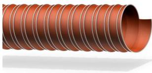
Führung von Luft und gasförmigen Medien mit hohen Eigen- bzw. Umgebungstemperaturen bei erhöhten mechanischen Anforderungen, Fahrzeugbau, Flugzeugbau, Schiffsbau, Maschinen- und Motorenbau, chemische Industrie, Kunststoffverarbeitung, Heißluftschlauch für Granulatrockner, Müllverbrennungsanlagen. Hochflexibel, leicht, kleinste Biegeradien, innen glatt, symmetrisches Faltverhalten, abknicksicher, bewegungsfest vulkanisierte Wandung und Federstahlwendel
