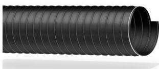
Leichter und flexibler Spiralschlauch aus PVC-beschichtetem Polyestergewebe. Absaugung von Farbnebeln und Lösungsmitteldämpfen, Klimatisierung und Entstaubung. Antistatisch ( $R < 10^8 \Omega$ )
