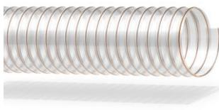
Absaugschlauch im Maschinen- und Apparatebau, der chemischen und Lebensmittel verarbeitenden Industrie. Transport leichter und abrasiver Medien wie Stäube, Fasern und Späne. Flexible, hohe Abriebfestigkeit, ausgezeichnete Beständigkeit gegen Öl- und Benzindämpfe. Antistatisch  $R < 10^8 \Omega$ .
