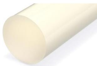
Geeignet für die Anwendung im medizinisch – technischen und Lebensmittelbereich. Entspricht FDA § 177.2600, USP Class VI and BfR XV Silikone. Hitzebeständig in Heißluft bis +200°C, geeignet für Dampfsterilisation +134°C max. 30 Minuten, Gammasterilisation und ETO.
